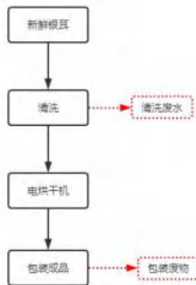
图 2-11 银耳烘干工艺流程及产排污环节图
