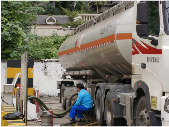
卸油油气回收系统
