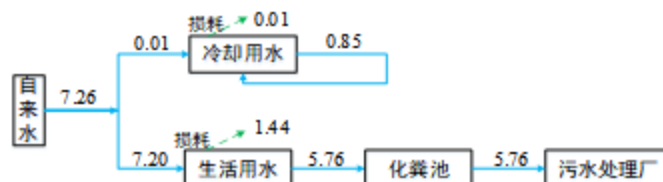
图 2-1 项目用水平衡图 单位：m 3 /d
