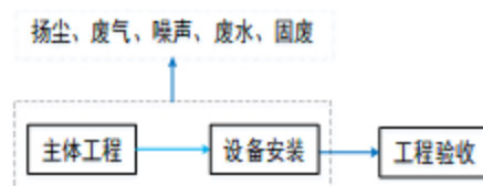
图 2-2 项目施工期流程及主要产污环节图
