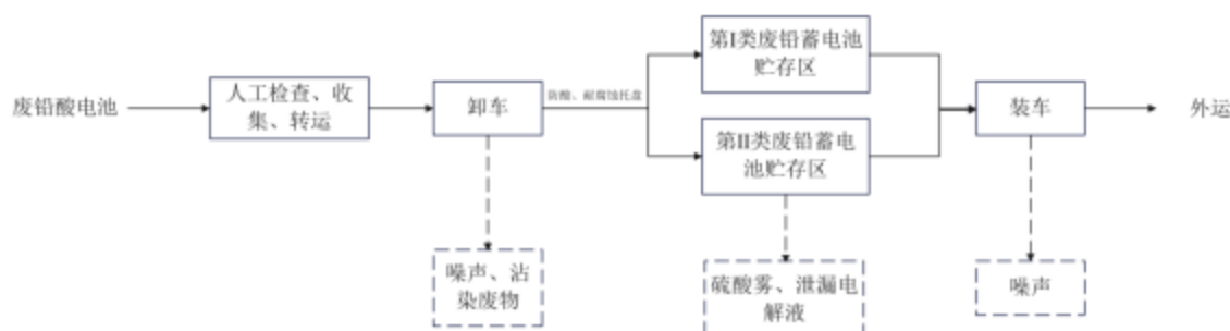
图 2-3 废铅酸蓄电池收集贮存工艺流程及产污节点图
