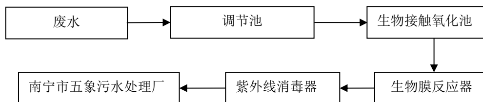
图 6.1-3 实验室废水处理系统工艺流程图
